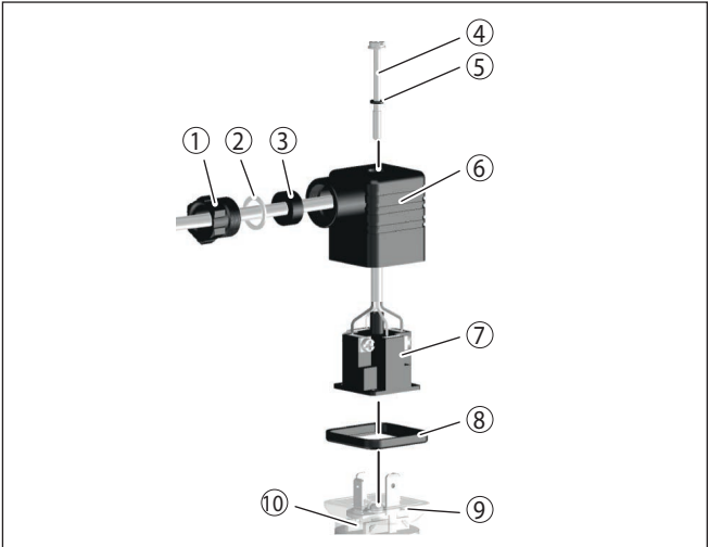
插图. 8: 阀门插头 ISO 4400 的连接方式
