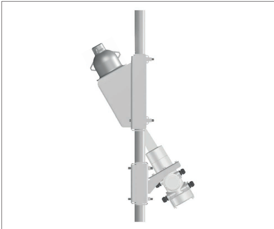
插图. 46: 夹持装置，用于斜向安装在 50 ... 100 mm (1.97 ... 3.94 in) 的管件上
