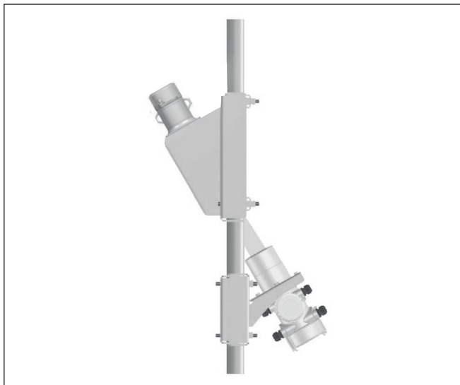
插图. 16: 将测量仪表倾斜 30° 安装在一个直径为 50 ... 100 mm (1.97 ... 3.94 in) 的管道上
