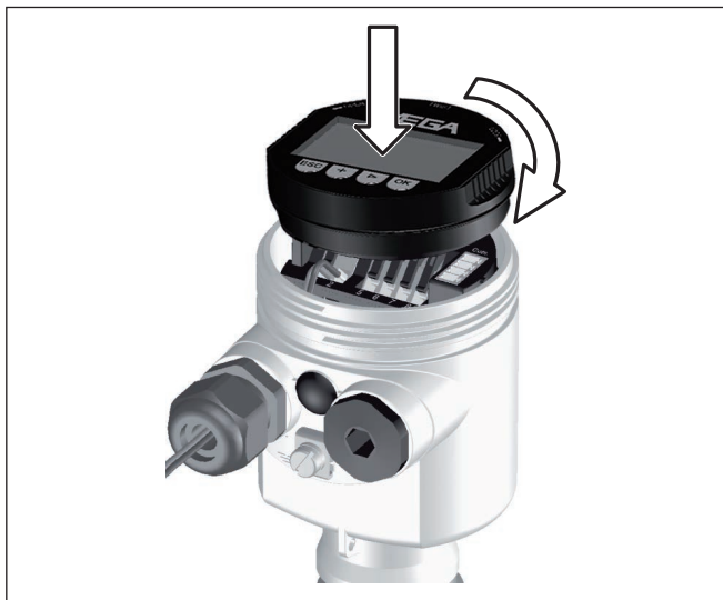
插图. 25: 将显示和操作模块装入单腔式壳体中
