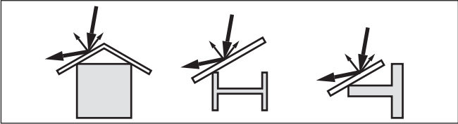
插图. 13: 用散射挡板来覆盖光滑的型材
