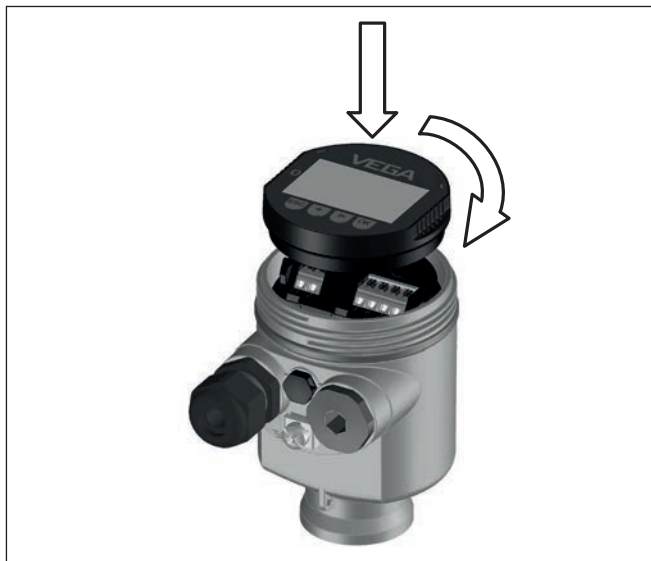
插图. 34: 将显示和调整模块装入单腔式壳体的电子部件腔中
