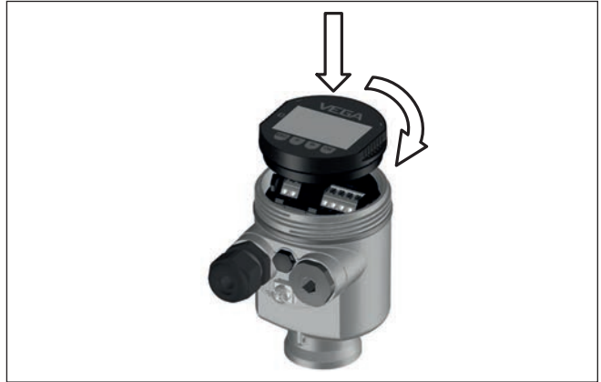
插图. 23: 将显示和调整模块装入单腔式壳体的电子部件腔中
