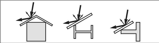
插图. 15: 用散射挡板来覆盖光滑的型材
