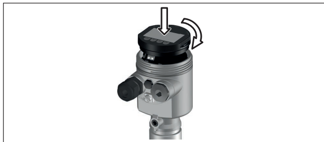
插图. 11: 将显示和调整模块装入单腔式壳体的电子部件腔中
