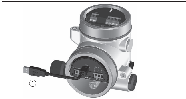
插图. 22: 电脑通过 USB 与 Modbus 电子部件相连接
