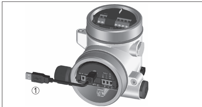
插图. 23: 电脑通过 USB 与 Modbus 电子部件相连接
