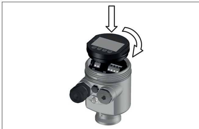
插图. 31: 将显示和调整模块装入单腔式壳体的电子部件腔中
