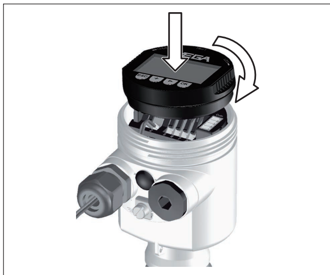
插图. 22: 使用显示和调整模块
