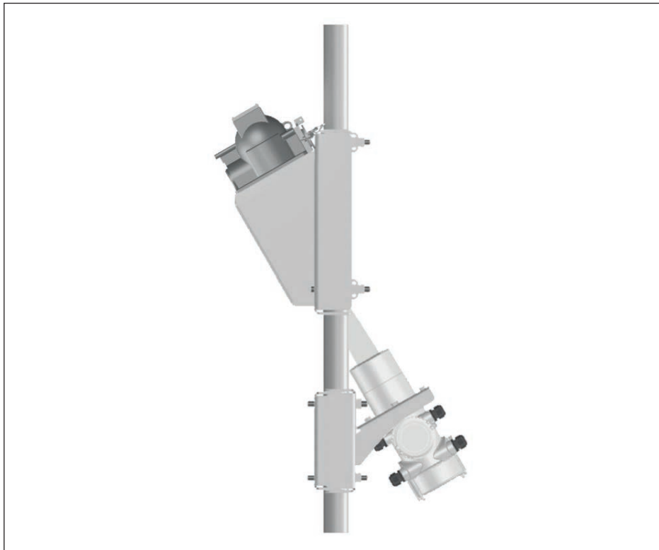
插图. 37: 夹持装置，用于斜向安装在 50 ... 220 mm (1.97 ... 8.66 in) 的管道上
