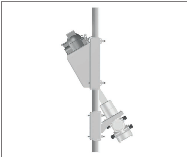
插图. 11: 将测量仪表倾斜 30° 安装在一个直径为 50 ... 100 mm (1.97 ... 3.94 in) 的管道上
