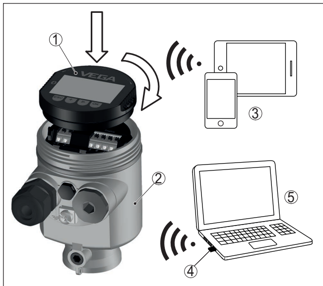
插图. 1: 与标准操作设备建立无线连接
