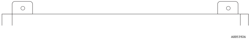
图 9. 外壳的顶部安装舌片
