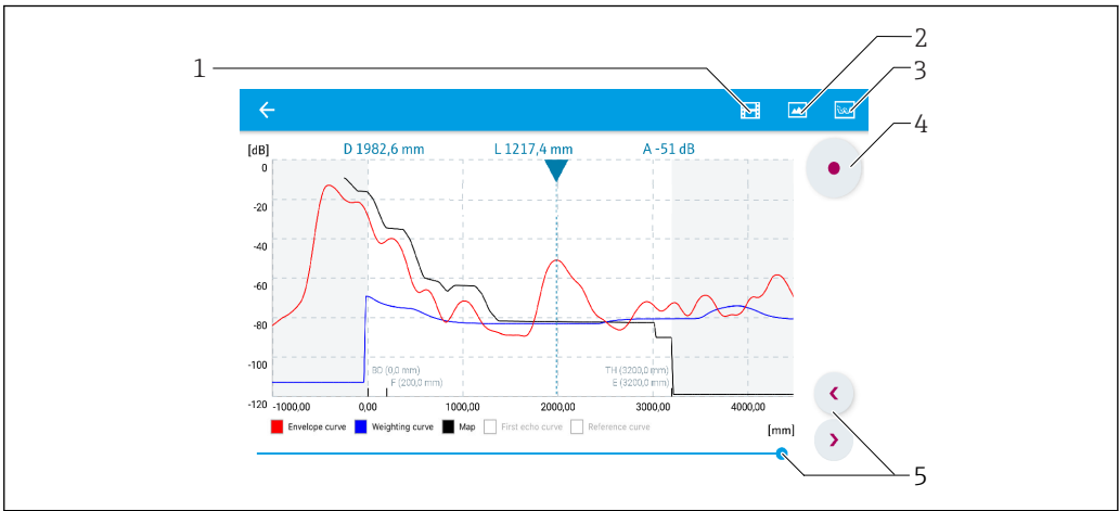
图 36 在 SmartBlue 中显示包络线；Android 视图
