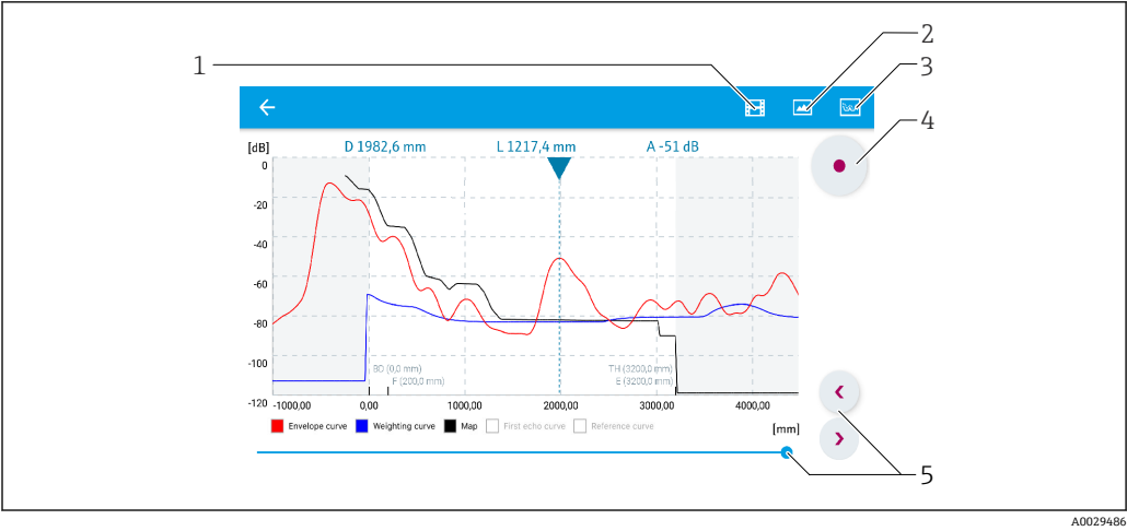
31 实例：Android 设备使用 SmartBlue 显示包络线
