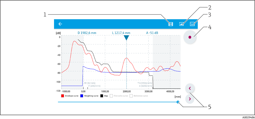
图 28 实例：Android 设备使用 SmartBlue 显示包络线
