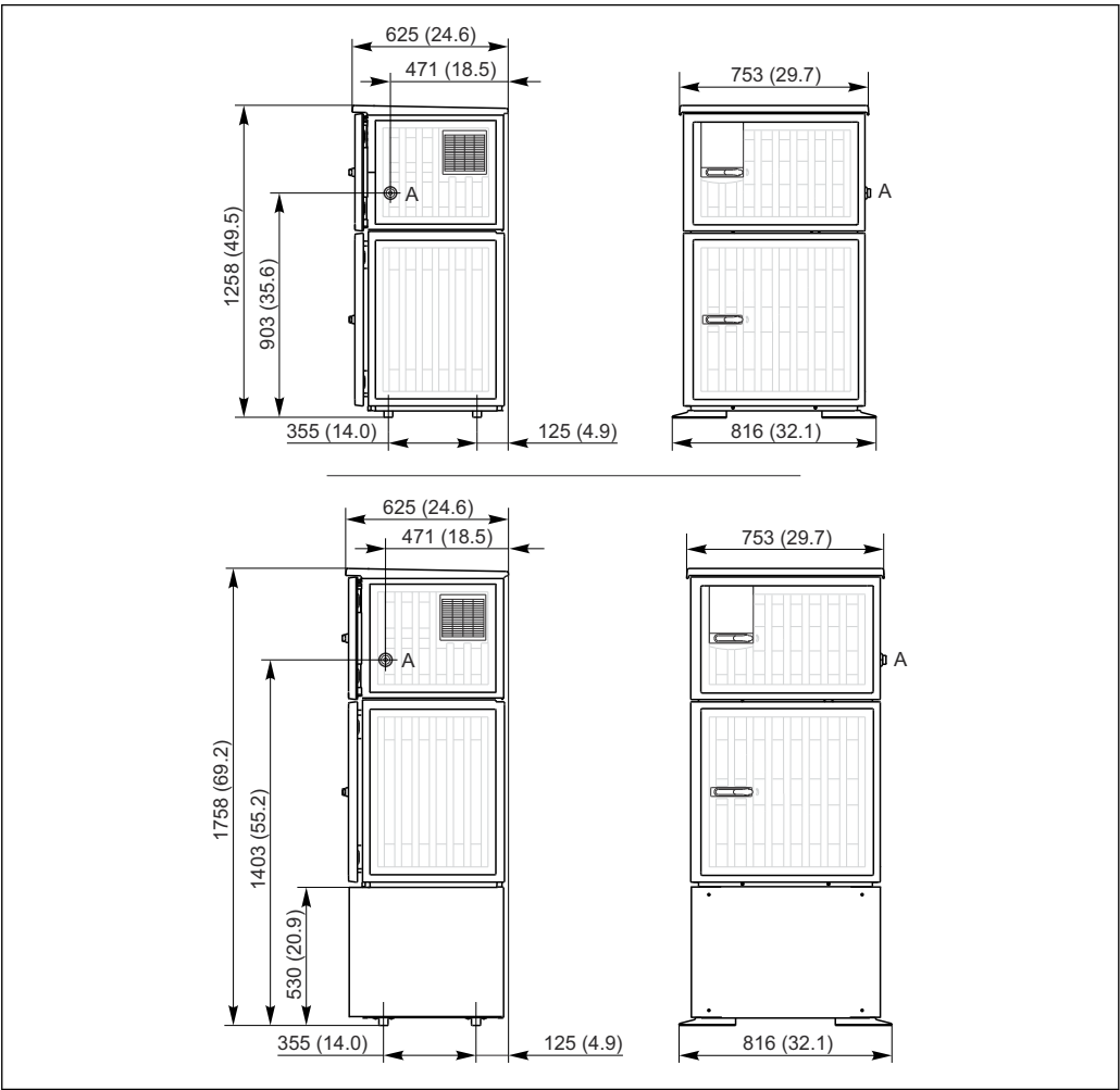
25 Liquistation 采样仪的外形尺寸示意图；塑料外壳，可选配立柜。测量单位 mm (in) A 吸液管道接口
