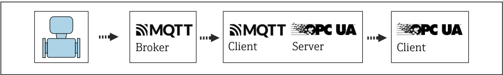
2 通过 MQTT 代理服务器、OPC-UA 服务器和 TLS 加密协议建立蜂窝无线电通信连接。
