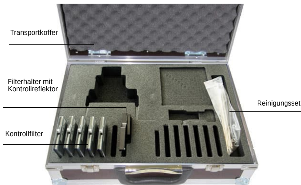
Abb. 11: Komponenten des Linearitätsprüfmittels
